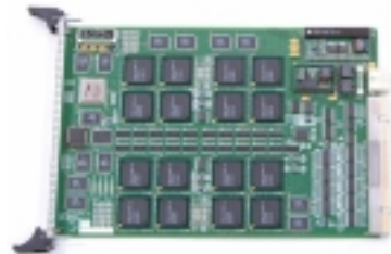
Prozessorboard des Hammer ® 100
